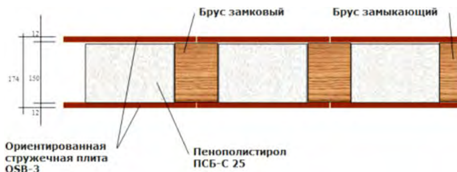
Рис.1. Конструкция композитной панели РаПан
