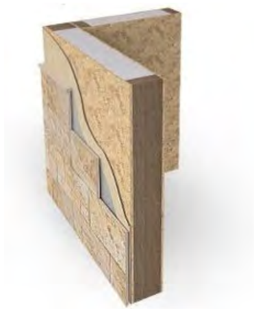
Рис.26. Монтаж стеновых панелей достигается с помощью замков, типа "паз-шпонка"
