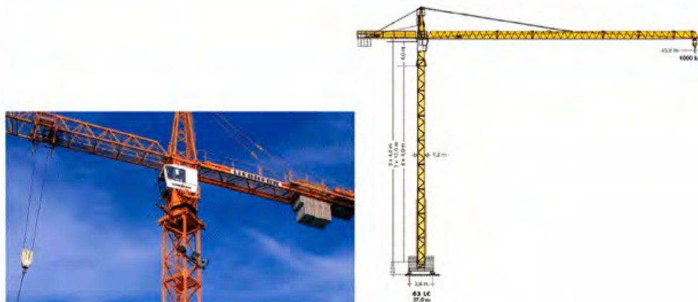
Рис.1. Башенный кран Liebherr 63 LC
