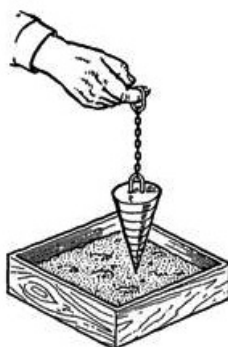
Рис.24. Проверка подвижности раствора эталонным конусом
