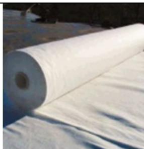
Рис.13. Защитный (разделительный) слой из геотекстиля
