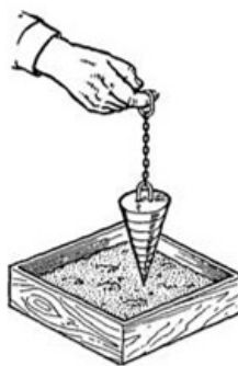
Рис.27. Проверка подвижности бетона эталонным конусом
