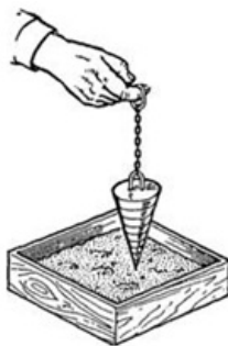
Рис.26. Проверка подвижности раствора эталонным конусом
