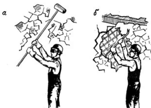
Рис.8. Отбивка штукатурки (разбивка и отдираание штукатурки)
