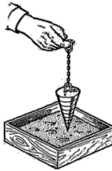
Рис. 16. Проверка подвижности бетона эталонным конусом
