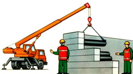
Рис.20. Передача сигналов в ограниченной зоне видимости
