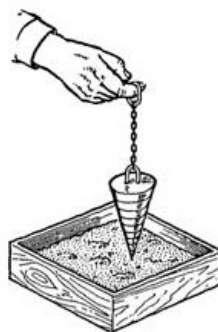
Рис.30. Проверка подвижности бетона эталонным конусом
