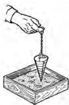
Рис.57. Проверка подвижности бетона эталонным конусом
