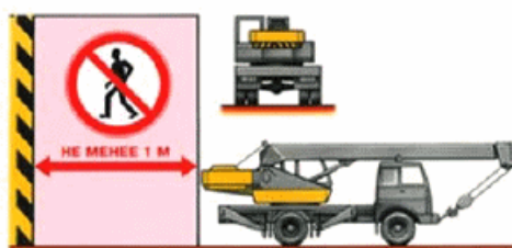
Рис.63. Схема установки крана вблизи препятствий
