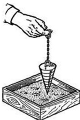
Рис.29. Проверка подвижности бетона эталонным конусом
