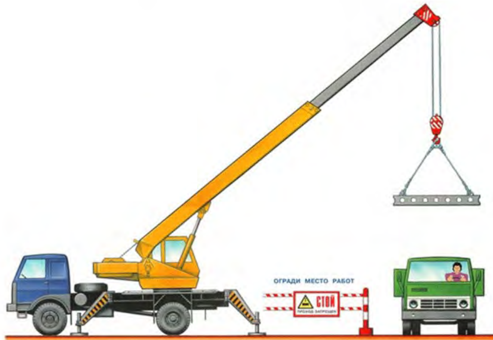
Рис.30. Схема установки автомобильного крана
