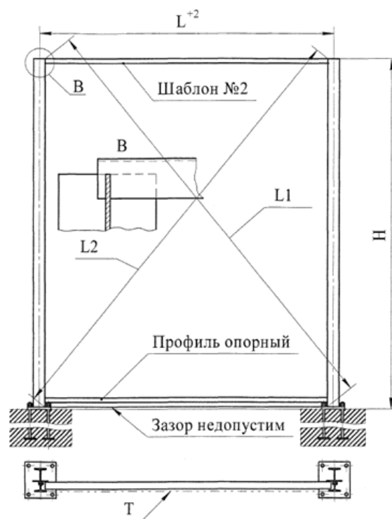
Рисунок 4 - Установка стоек шумозащитного экрана
