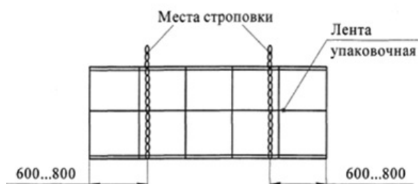
Рисунок 11 - Строповка светопрозрачной панели
