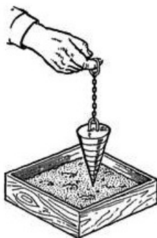
Рис.27. Проверка подвижности раствора эталонным конусом
