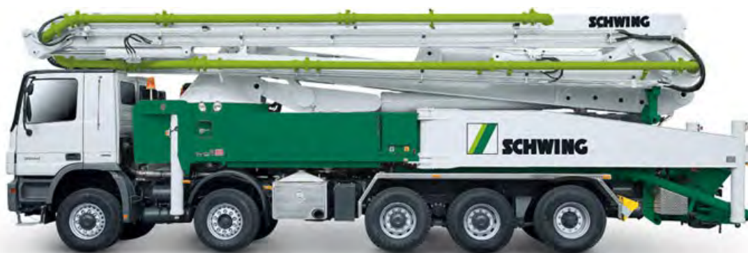
Рис.1. Автобетононасос SCHWING S36 SX
