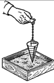
Рис.18. Проверка подвижности бетона эталонным конусом
