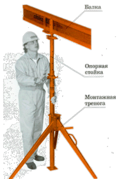
Рис.9. Выверка балок-ригелей по высоте
