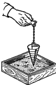
Рис.20. Проверка подвижности бетона эталонным конусом
