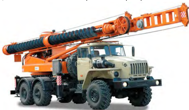
Рис.11. Бурильно-сваебойная машина БМ-811
