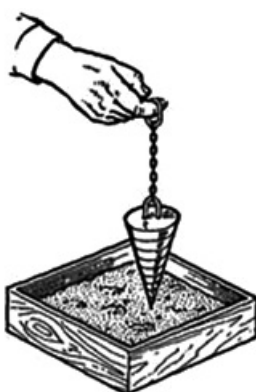
Рис.33. Проверка подвижности раствора эталонным конусом
