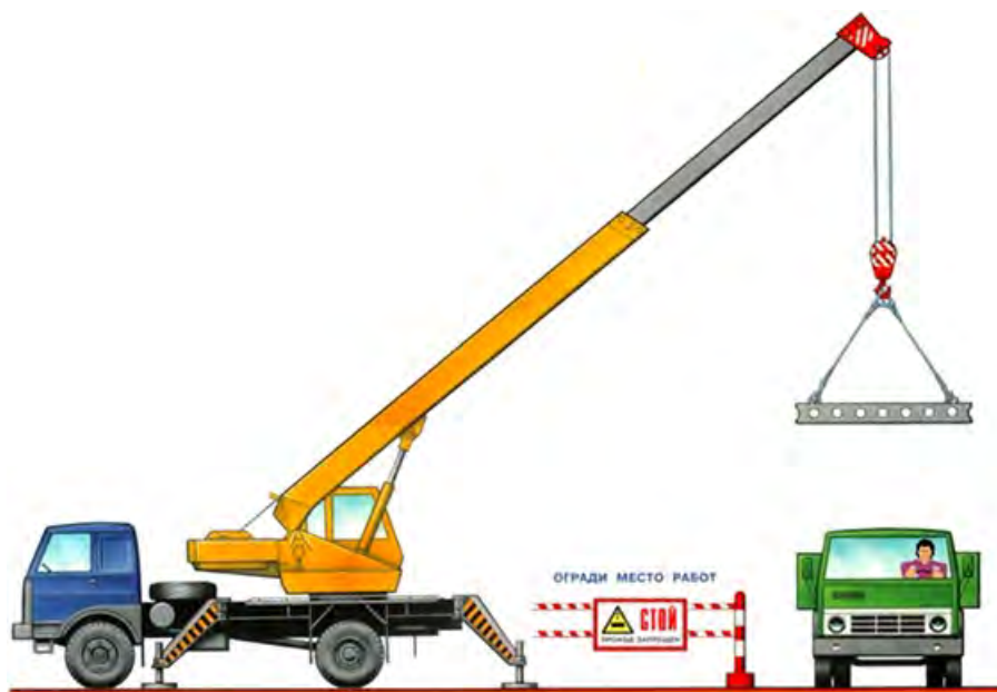
Рис.17. Схема установки автомобильного крана
