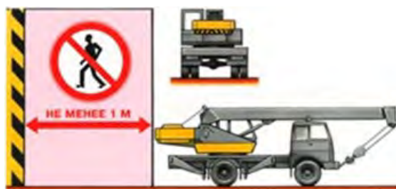
Рис.16. Схема установки крана вблизи препятствий
