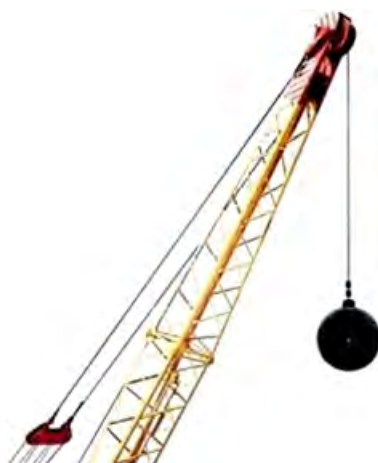
Рис.9. Обрушение стен шар-бабой подвешенной к стреле экскаватора
