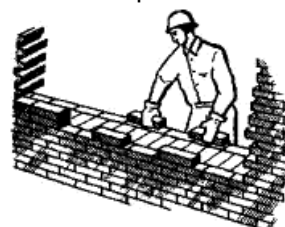
Рис.25. Раскладка кирпича для ложкового ряда внутренней версты
