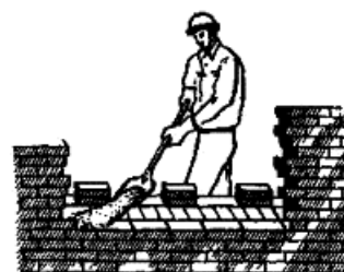
Рис.19. Расстилание раствора для ложкового ряда наружной версты
