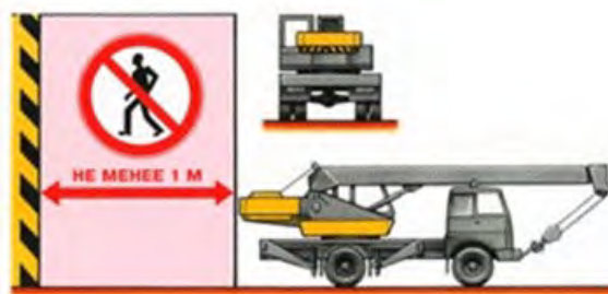
Рис.25. Схема установки крана вблизи препятствий
