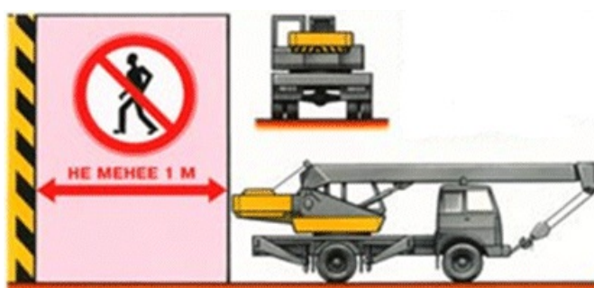
Рис.22. Схема установки крана вблизи препятствий
