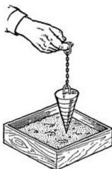
Рис.28. Проверка подвижности бетона эталонным конусом
