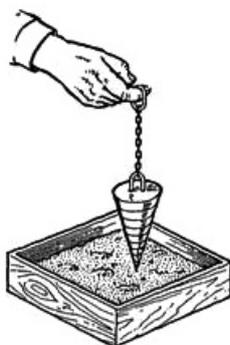
Рис.31. Проверка подвижности раствора эталонным конусом
