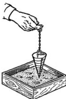
Рис.32. Проверка подвижности бетона эталонным конусом
