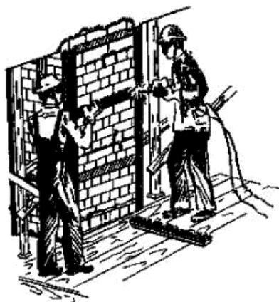
Рис.22. Прихватка сваркой планок металлического каркаса
