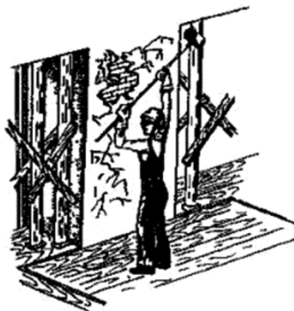
Рис.21. Отбивка штукатурки на простенке
