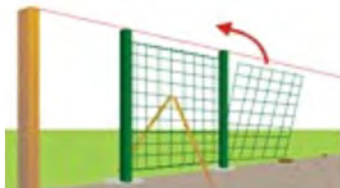
Рис.14. Установить вторую панель, закрепить ее к столбу
