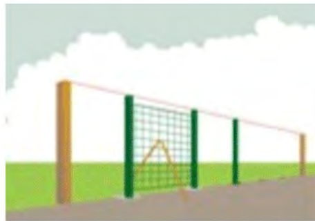
Рис.13. Установить секцию вертикально в выкопанные ямы
