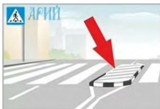
Рис.16. Схема островка безопасности с ограждающими элементами
