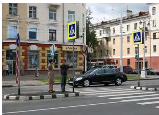
Рис.17. Островок безопасности из разметки и бетонных ограждающих элементов
