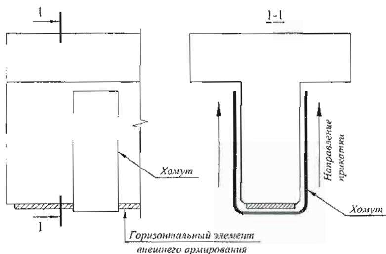
Рисунок 13 – Схема установки вертикальных хомутов в балочных конструкциях
