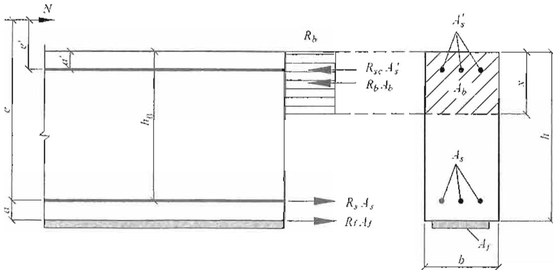
Рисунок 3 – Схема усилий и эпюра напряжений в сечении, нормальному к продольной оси внецентренно сжатого железобетонного элемента с внешним армированием из композитных материалов, при расчете по прочности
