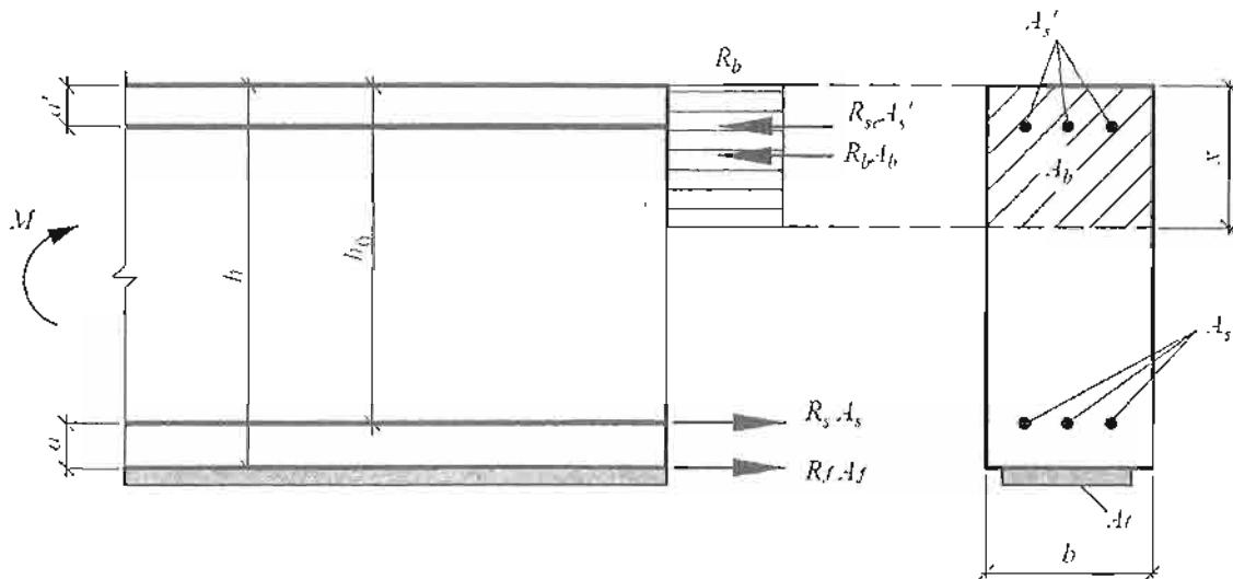
*Рисунок 1 – Схема усилий и эпюра напряжений в сечении, нормальному к продольной оси изгибающего железобетонного элемента с внешним армированием из композитных материалов, при его расчете по прочности*
