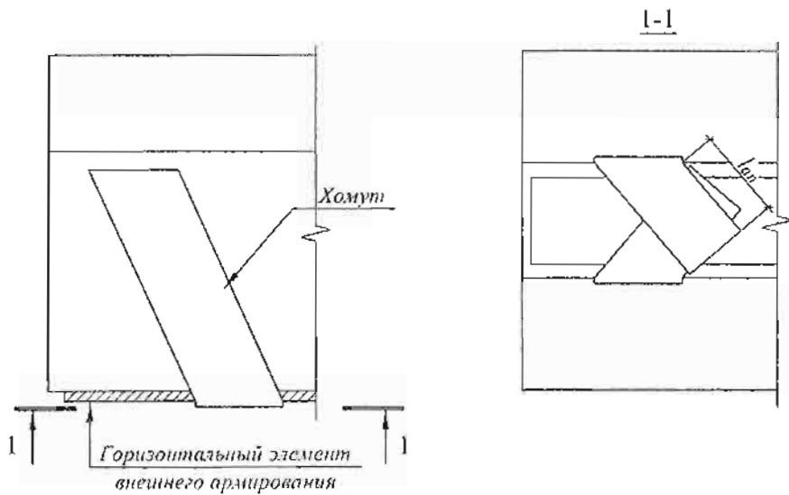
Рисунок 14 – Схема установки наклонных хомутов в балочных конструкциях
