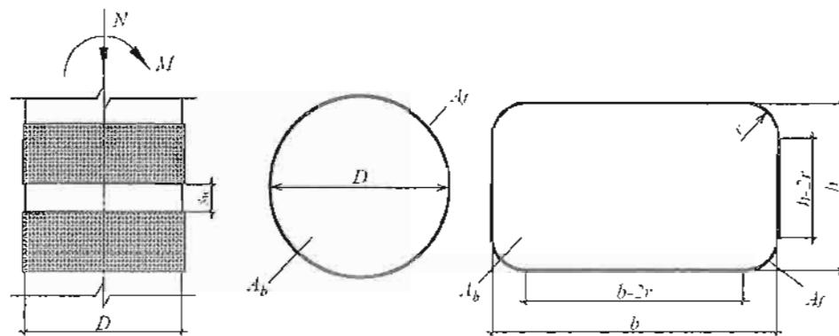
**Рисунок 4 – Усиление винециним армированием из композитных материалов в поперечном направлении**
