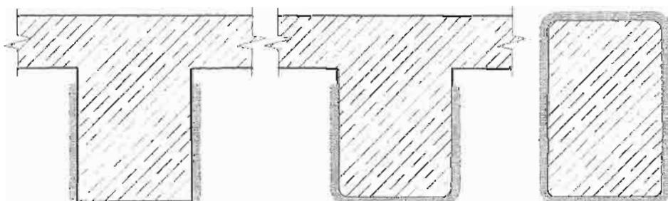
Рисунок 8 – Схемы усиления наклонных сечений элементов
