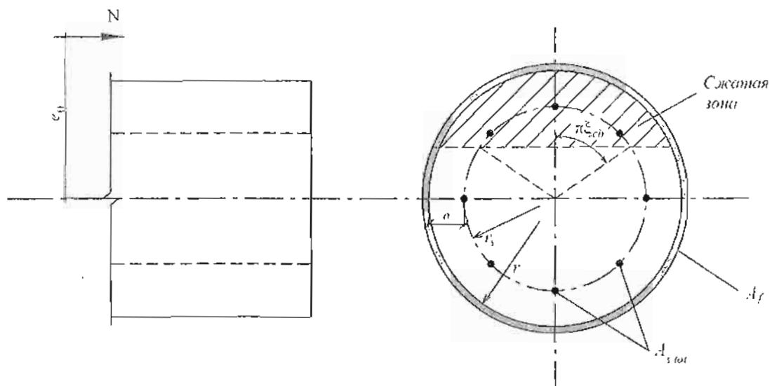
Рисунок 5 – Схема усилий и эпюра напряжений в сечении, нормальному к продольной оси сжатого элемента круглого сечения с внешним армированием из композитных материалов в поперечном направлении
