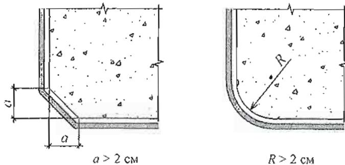
*Рисунок II – Подготовка углов конструкции перед наклеиванием сеток, холстов и других тканых материалов*
