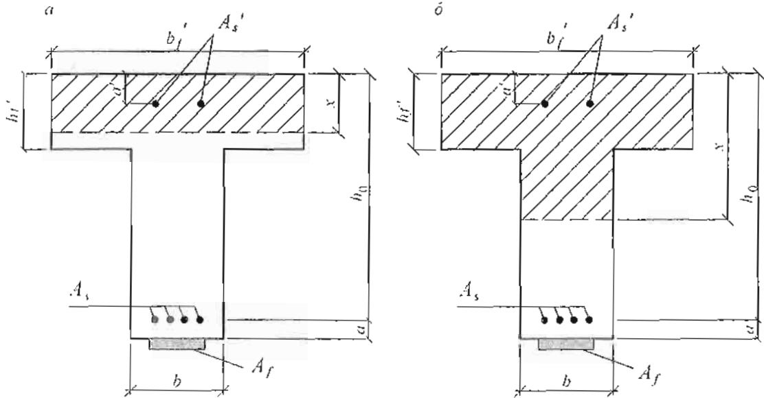
Рисунок 2 – Положение границы сжатой зоны в сечении изгибающего железобетонного элемента с внешним армированием из композитных материалов
