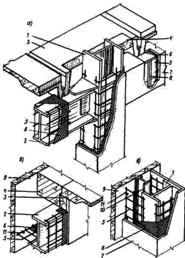
Рис.2. Фрагменты металлоконструкций с огнезащитной облицовкой из штукатурок различного состава
