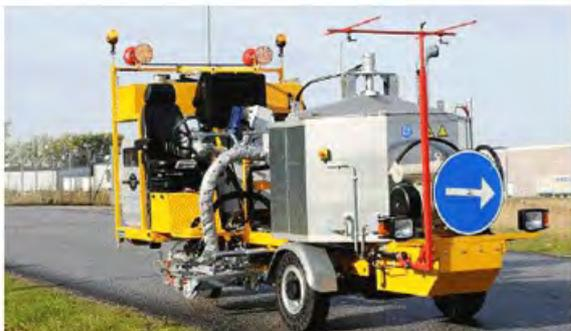
Рис.1. Самоходная разметочная машина
