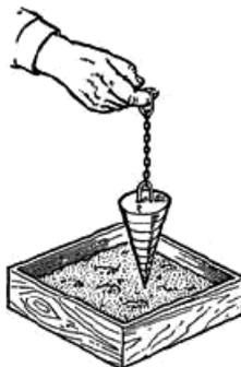
Рис. 15. Проверка подвижности бетона эталонным конусом
