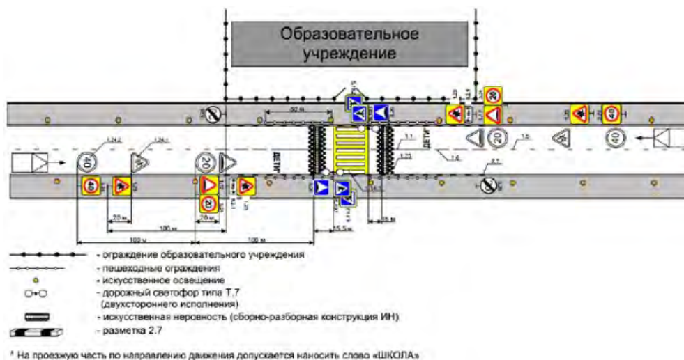
Рис.15. Схема организации движения на пешеходном переходе при установленных "лежачих полицейских"
