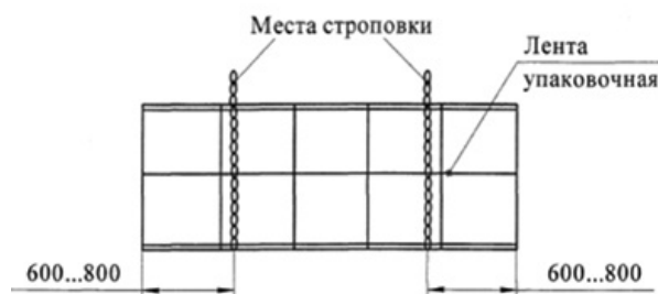
Рисунок 11 - Строповка светопрозрачной панели
