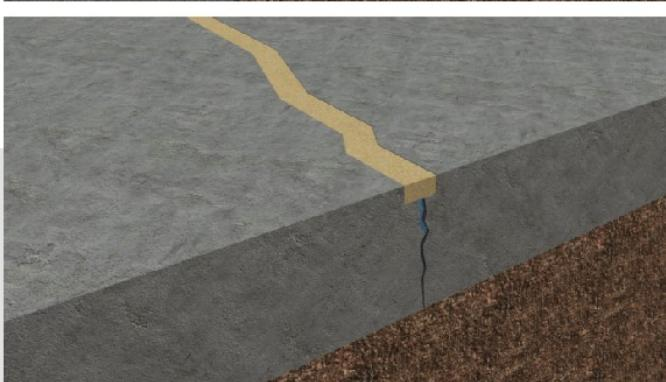
Шов/трещина расшивается, зачеканивается ремонтным составом САМКРИТ 40. При наличии активных течей для герметизации используется гидропломба ГИДРОСТОП
