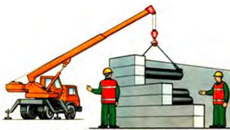
Рис.7. Передача сигналов в ограниченной зоне видимости
