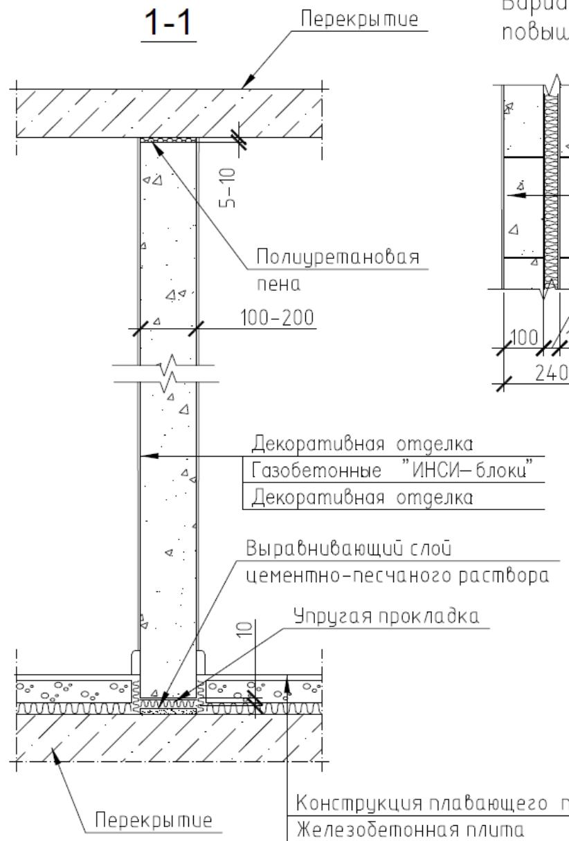
Вариант I конструкции перегородки повышенной звукоизоляции.
