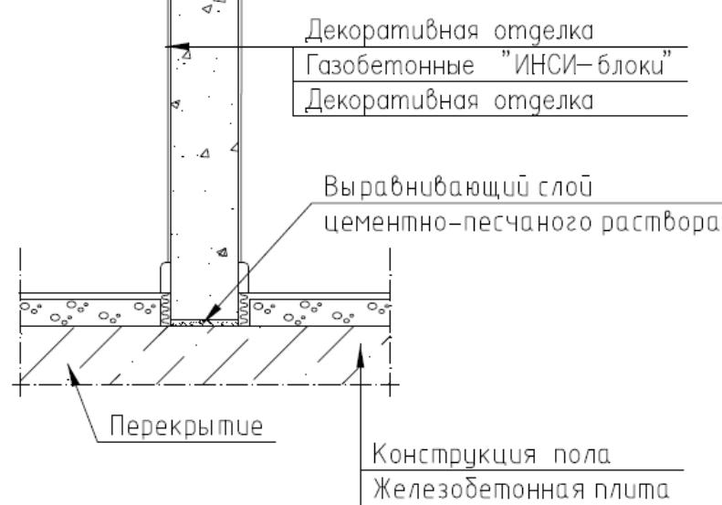
*Вариант II конструкции перегородки.*
