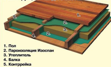
применение материалов ИЗОСПАН в конструкциях ЧЕРДАЧНЫХ ПЕРЕКРЫТИЙ
