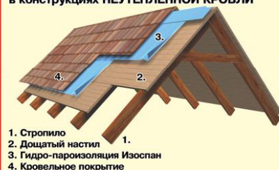
применение материалов ИЗОСПАН в конструкциях НЕУТЕПЛЕННОЙ КРОВЛИ
