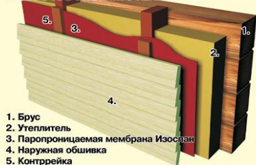
применение материалов ИЗОСПАН в конструкциях СТЕН С НАРУЖНЫМ УТЕПЛЕНИЕМ
