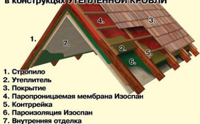
применение материалов ИЗОСПАН в конструкциях УТЕПЛЕННОЙ КРОВЛИ
