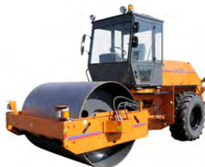
Рис.3. Грунтовый виброкаток ДУ-85
