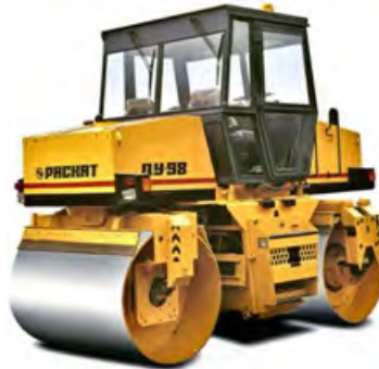
Рис.9. Гладковальцовый каток ДУ-98
