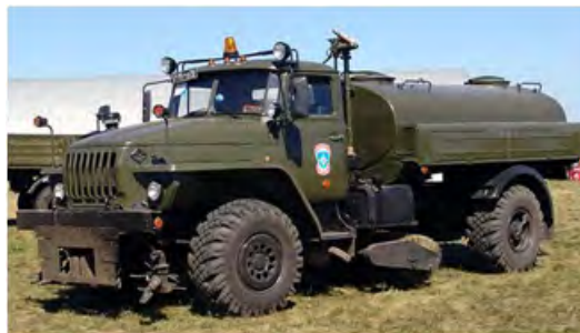
Рис.6. Поливомоечная машина ПМ-3У
