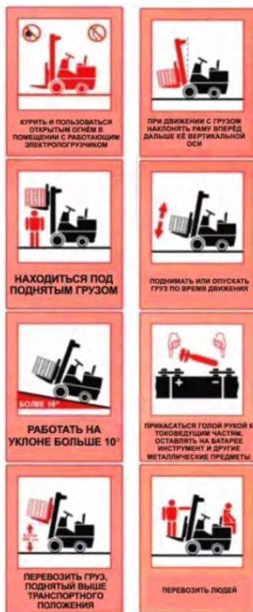
Рис.20. Водителю электропогрузчика и электрической тележки запрещается
