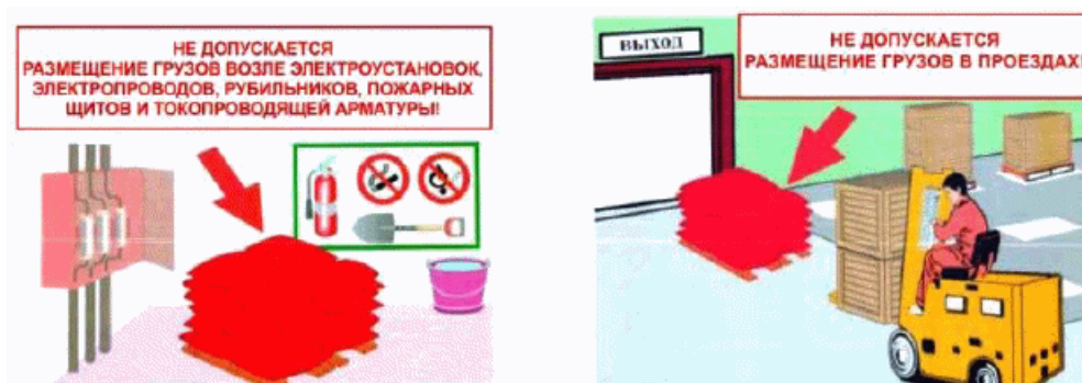
Рис. 18. Не допускается загромождать проезды, а также подходы к электрическим щитам и средствам пожаротушения
