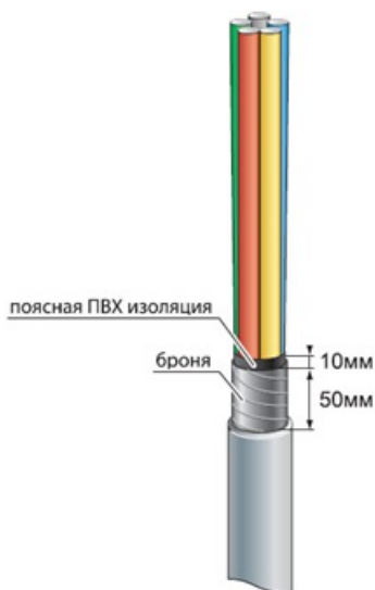
Рисунок 8б - Операции для кабелей с броней, без металлических оболочек и экранов
