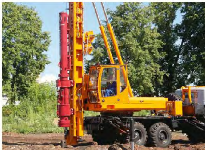
Рис.18. Забивка свай-оболочек бурильно-сваебойной машины БМ-811
