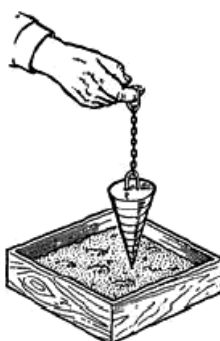
Рис.34. Проверка подвижности бетона эталонным конусом
