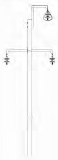
Схема расположения РДИП-10-IV-УХЛ1 на промежуточной опоре П10-1
