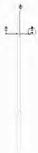
Схема расположения РДИП-10-IV-УХЛ1 на промежуточной опоре ПаБ10-4
