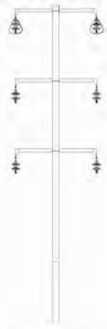
Схема расположения РДИП-10-IV-УХЛ1 на промежуточной опоре П16.4-1
